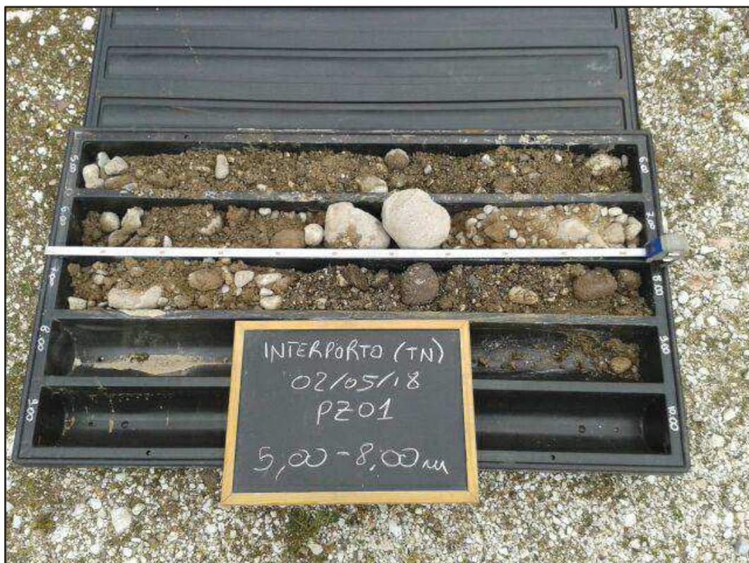
Sondaggio a carotaggio continuo PZ1 – Cassette catalogatrici
