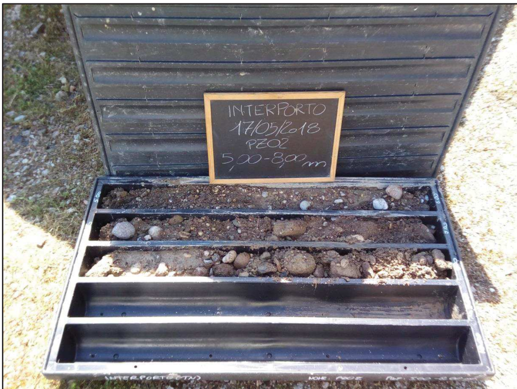
Sondaggio a carotaggio continuo PZ2 – Cassette catalogatrici
