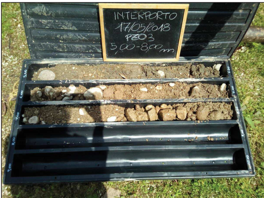
Sondaggio a carotaggio continuo PZ3 – Cassette catalogatrici
